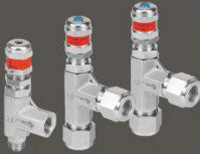
**Relief Valves** جهت استفاده در انواع خطوط ابزار دقیق و به منظور کنترل فشار، در انواع SRVL با فشار ۲۱ بار و SRVH با فشارهایی تا ۴۱۴ بار و دماهای ۲۳- تا ۲۰۴ درجه سانتی گراد
