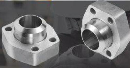
**Hydraulic Flanges** در سرویس های هیدرولیکی فشار قوی، در دماهای ۲۵- تا ۲۰۴ درجه سانتی گراد و تا فشارهای ۴۰۴ بار (آب بندی با اورینگ های جنس Viton)
