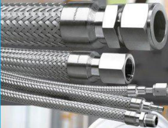
**Flexible Metal Hoses-SFH Series** در سرویس های هیدرولیکی فشار قوی، ارتعاش بالا، عدم همراستایی دو تجهیز و ... تا دماهای ۵۳۸ درجه سانتی گراد و فشارهای ۱۱۰ بار
